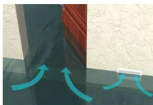
Situation initiale : l'eau pénètre par les portes et entrées d'air.
