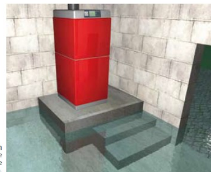
Protection d'un équipement de chauffage par surélévation.
